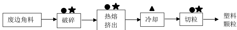
图 4-1 再生塑料颗粒工艺流程示意图
