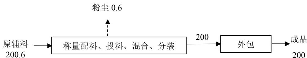
图 3-11 预混剂产品物料平衡图 t/a
