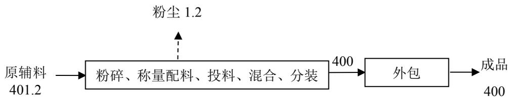
图 3-10 散剂产品物料平衡图 t/a
