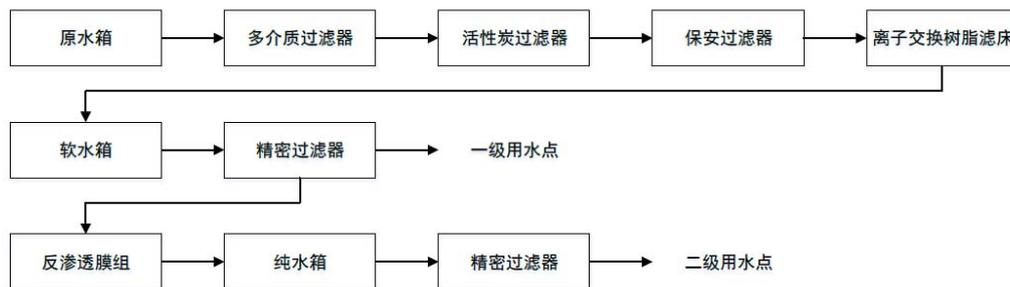
图 7 软水、纯水制备系统工艺流程
