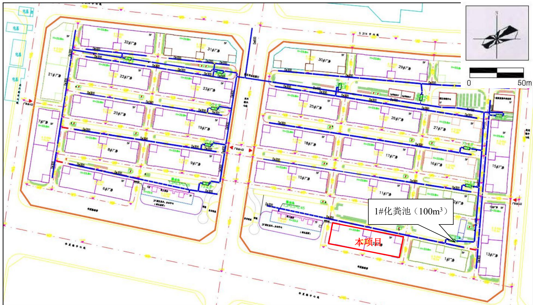
附图 8-1 鞋业产业园污水管网图
