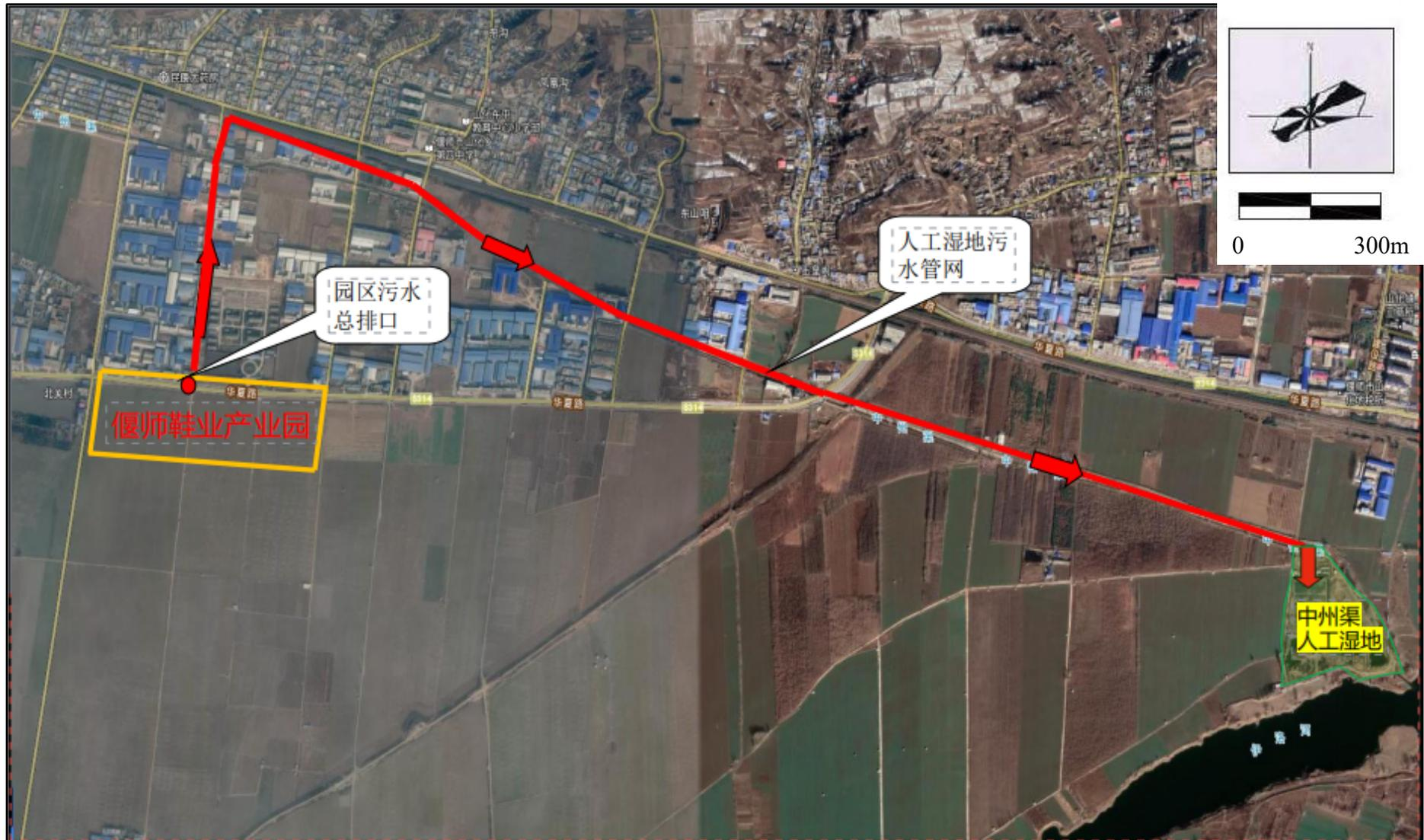
附图 8-3 偃师市鞋业产业园污水总排口至中州渠污水管道铺设示意图
