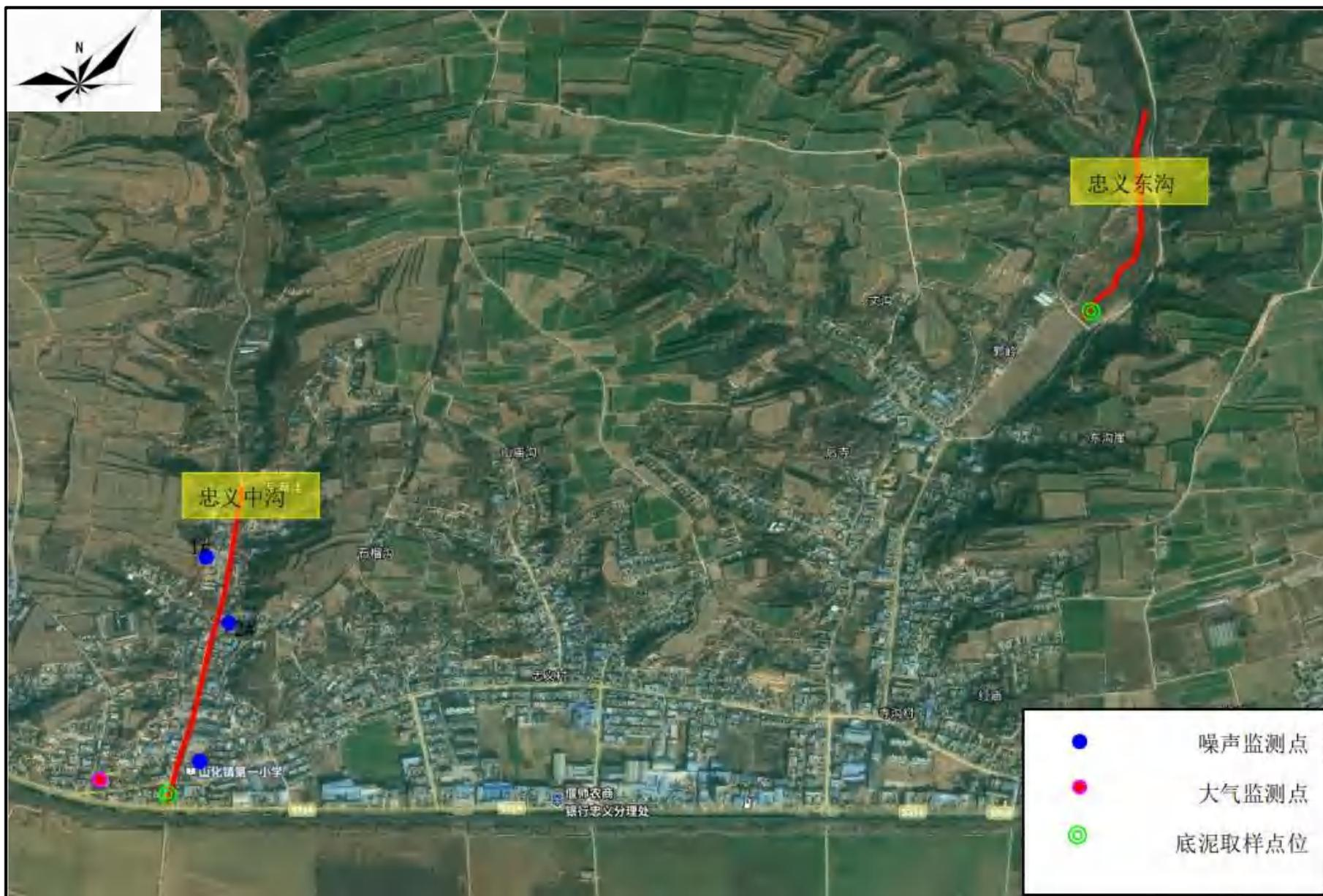
附图 5-4 本项目监测布点示意图（比例尺 1: 7500）
