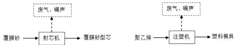
图 5 覆膜砂芯、塑料模具生产工艺流程及产污环节示意图
